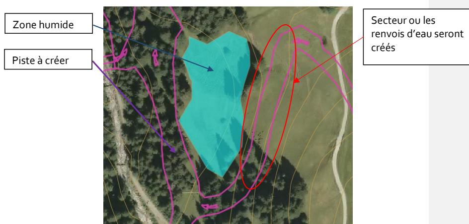
Figure 2 Création de renvois d'eau au niveau de la piste à créer pour préserver la zone humide n°20
