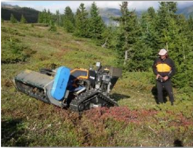
Photo 51 Illustrations d'actions de débroussaillage à l'aide du gyrobroyeur
