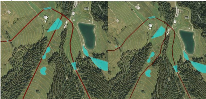
Carte 43 Implantation des réseaux neige avant le travail de prise en compte des zones humides (à gauche) et après (à droite)
